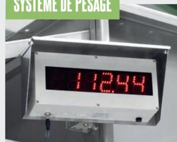
Un écran LED avec un affichage bien visible vous renseigne sur le poids rempli de l'installation. Comme pour le panneau web, l'affichage LED du système de pesage est protégé dans un capot de protection contre les intempéries en acier inoxydable et peut également être monté sur le BIG-Mix V à un endroit convivial.
