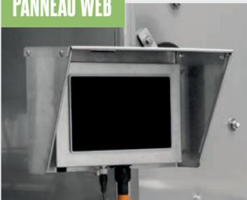
Le panneau web est l'élément de commande de l'installation. Installé dans un boîtier en acier inoxydable avec un capot de protection contre les intempéries, l'écran peut être placé à un endroit convivial sur le BIG-Mix V et, si nécessaire, être intégré à d'autres interfaces.
